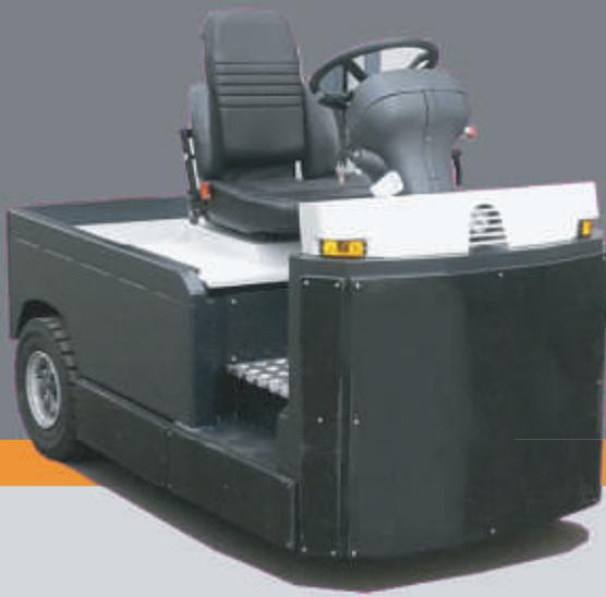
Der tragende "Brueckenrahmen" ist aus überdimensionierten Profilen und "shock-resistant", Laser geschnittene und elektroverschweißten Profilen. So können die Leistung und das Drehmoment des Drehstrommotors am Besten umgesetzt werden. Bei diesem Schlepper kann die Batterie nach oben hin, oder seitlich gewechselt werden
