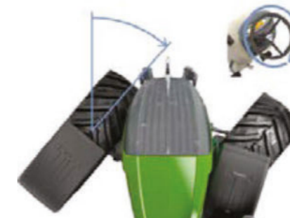
Met VarioActive leidt één keer ronddraaien van het stuur al tot een volledige stuuruitslag.
