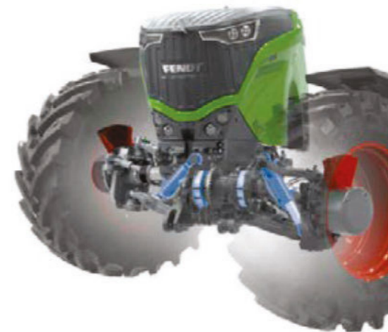
Vooras met per wiel remsysteem en niveaugeregelde vering
