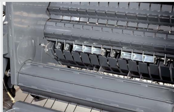
Zwei aggressive, vordere Walzen mit selbstreinigenden Abstreifern bewirken eine unmittelbare Ballenrotation
