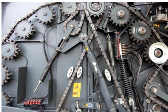
Der Antriebsstrang der Fendt Pressen ist für die härtesten Einsatzbedingungen konstruiert. Eine Heavy Duty 1 ¼" Antriebskette treibt die Walzen der Ballenkammer an. Alle Modelle sind mit einseitiger Weitwinkel-Gelenkwelle und einer Nockenschaltkupplung ausgestattet.
