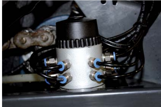
Die automatische Kettenschmierung gehört zur Serienausstattung und wird permanent angetrieben.
