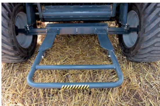
Die Ballenrampe lässt den Ballen weit nach hinten rollen
