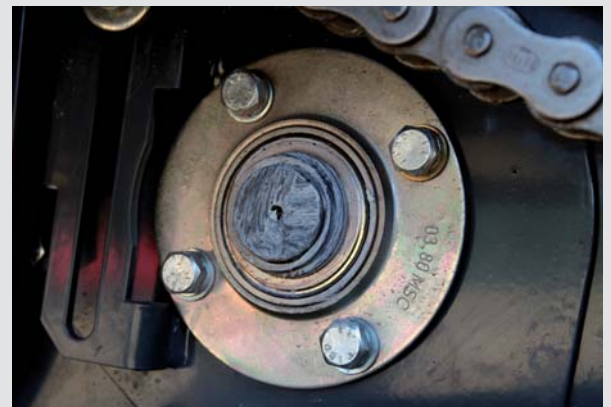
Alle Presswalzen sind mit extraschweren Lagern ausgestattet.
