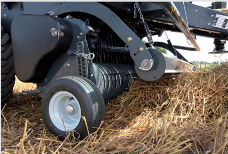
Die leicht in der Höhe verstellbaren Pickup-Lasträder sind luftbereit. Das einzigartige Pickup-Design ermöglicht eine kompakte Position der Tasträder und vermeidet eine große Transportbreite.
