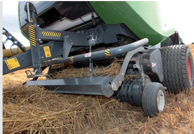
Der Rollenniederhalter sorgt für eine Vorverdichtung des Erntegutes und unterstützt den Materialfluss. Besonders bei ungleichmäßigen Schwaden wird der Fluss verbessert.
