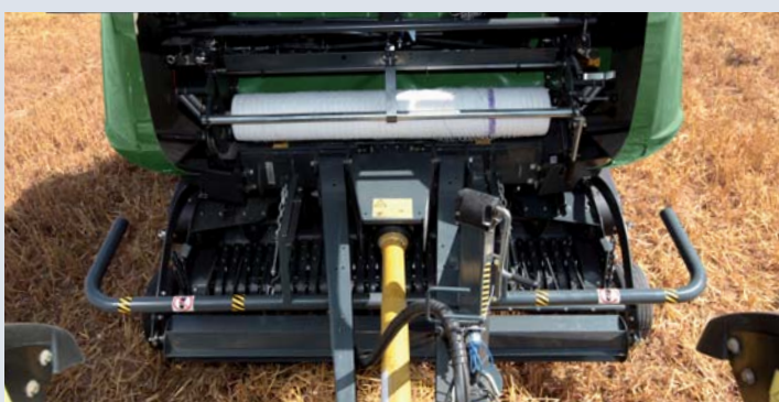
Die Netzbindung ist vom Traktor aus einseh- und kontrollierbar.
