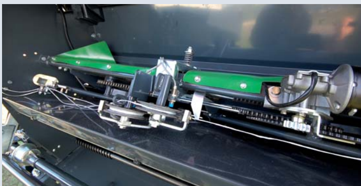
Schnell ablaufende Doppelgarnbindung.
