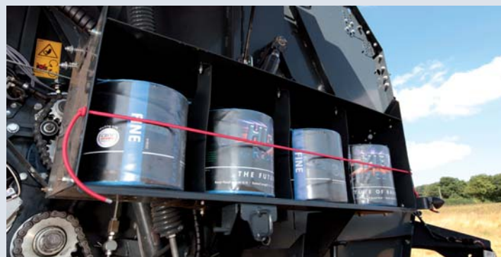
Einfach zugängliche Fächer für Netz- und Garnrollen.
