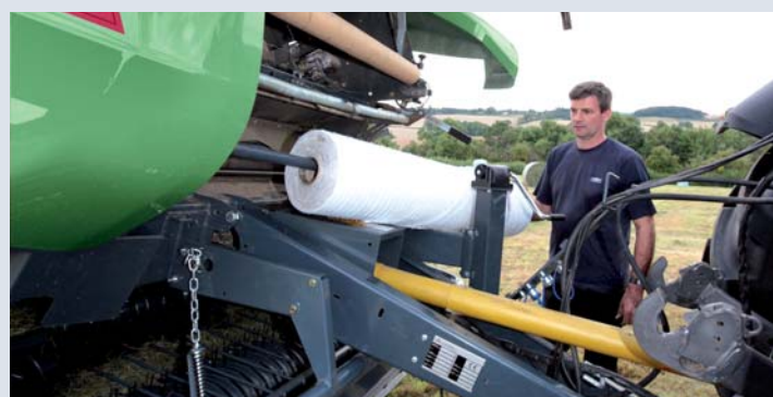
Sehr niedrige Ladehöhe - einfacher Netzrollenwechsel.
