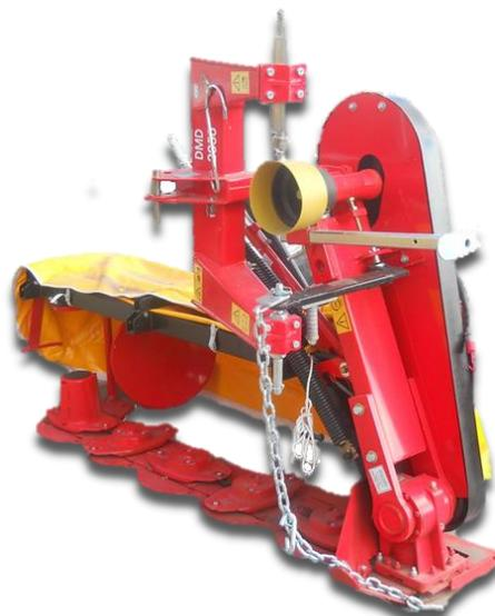
La altura de corte de la máquina es regulada por el brazo del tercer punto.
