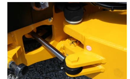
Das Knick-Pendelgelenk ist wartungsfrei und mit einer erweiterten Werksgarantie ausgestattet.
