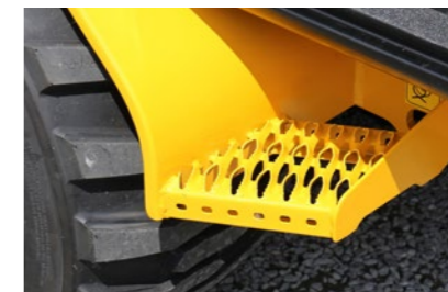
Die herausgezogene Trittstufe erleichtert den Aufstieg enorm.
