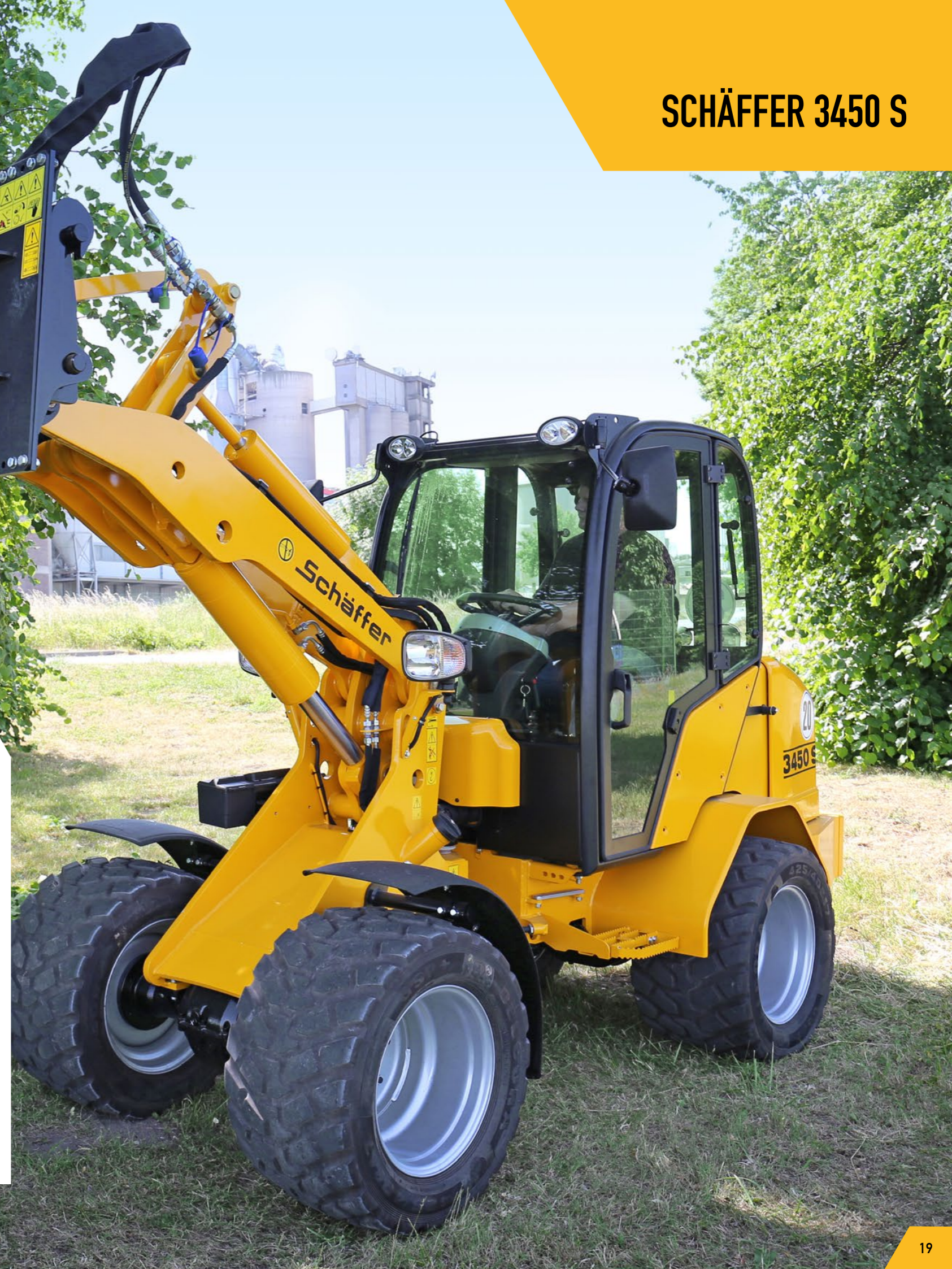
Der 3450S kann Paletten von 2,0 t verfahren. Ein schmaler und sehr niedriger Vorderwagen optimiert die Sicht des Fahrers auf das Werkzeug.
