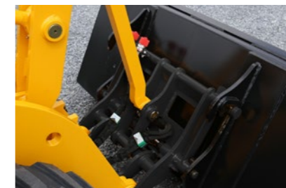
Mit der Werkzeugaufnahme „SWH“ lassen sich alle Anbauwerkzeuge schnell an- und abkoppeln. Die Hydraulische Verriegelung ist serienmäßig.
