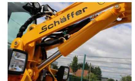
Der Hubzylinder wurde entsprechend der hohen Kipplast besonders stark dimensioniert. Kugelgelenkaugen schützen vor Torsion.
