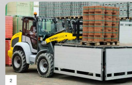
L'unità di carico a cinematica parallela permette di tenere sempre sotto controllo la forza di sollevamento e il carico. Grazie all'ampio angolo di carico e scarico, anche con la benna completamente carica non si perde mai materiale e lo svuotamento si svolge in modo fluido e senza traccia di residui.
