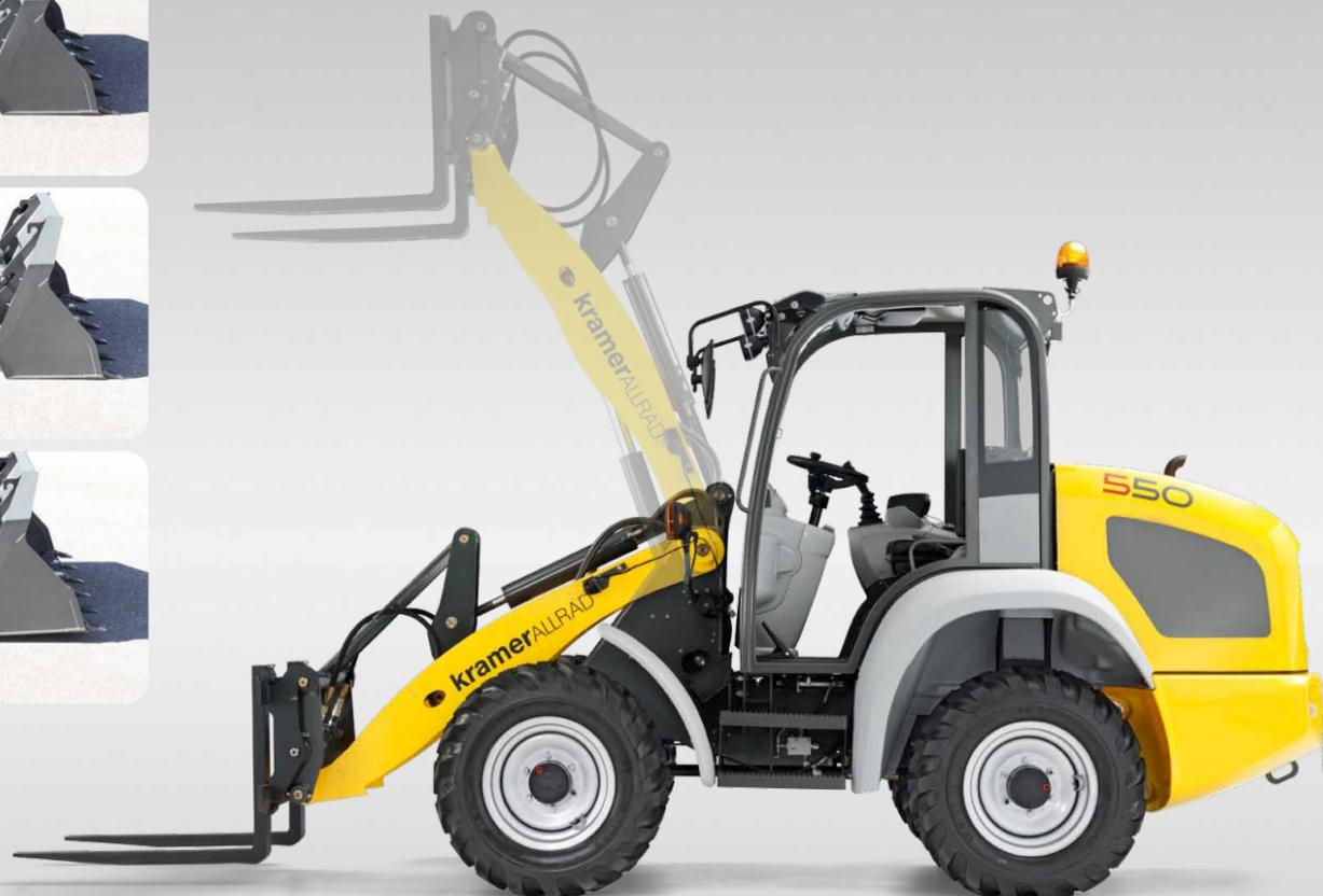
**Sistema idraulico di attacco rapido e unità di carico a cinematica parallela:**
