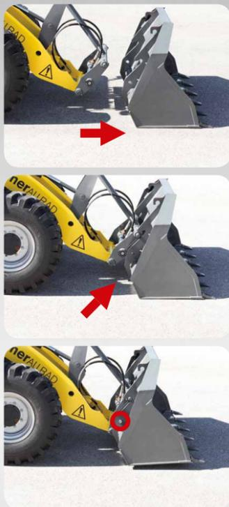
La cinematica parallela dell'unità di carico mantiene il carico sempre perfettamente in equilibrio sia durante l'utilizzo della benna che con le forche
