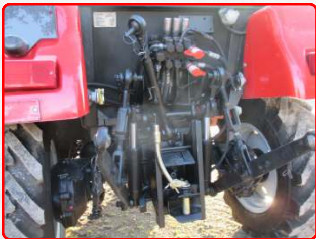
MTS 422 mit höhenverstellbarer Anhängerkupplung, Ein- und Zweileiterbremse serienmäßig
