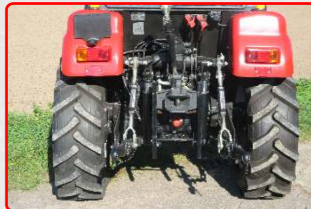
Heckhubwerk Kat 2 mit 2,8t Hubkraft, höhenverstellbare Anhängerkupplung mit Automatikzugmaul, Bolzen 38 mm, Ein- und Zweileiterbremse serienmäßig
