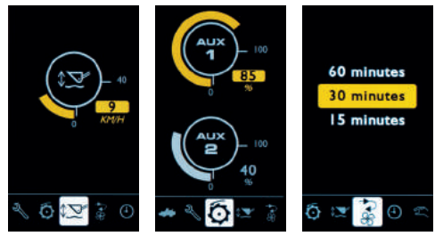
Einstellbare Geschwindigkeit für SRS Einstellbare Zusatzkreisleistung Einstellbare Lüfterumkehrintervalle
