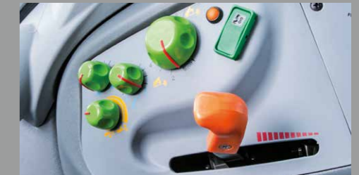
Elevador trasero de regulación electrónica (EHR) Memoria de régimen de motor para facilitar las labores.
