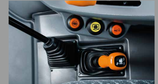
Accionamiento electrohidráulico de la TDF, tracción a las cuatro ruedas y bloqueo del diferencial de serie (LS y GS).
