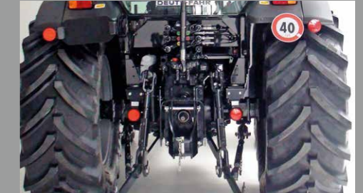
El elevador trasero de la serie 5D con cilindros de elevación adicionales eleva hasta 3.600 kg y, por lo tanto, puede dirigir todos los equipos comunes de esta clase de potencia.
