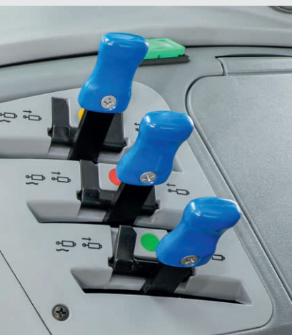
maximaal 3 mechanische hulpbesturingsventielen zijconsole geplaatst.
