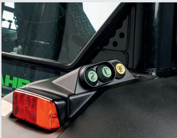
↑ Handige bedieningselementen op het achterspatbord voor de hefinrichting en aftakas achter.
