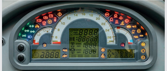
↑ De console met analoge en digitale display-velen geeft de bestuurder een overzicht van alle gegevens van de tractor.
