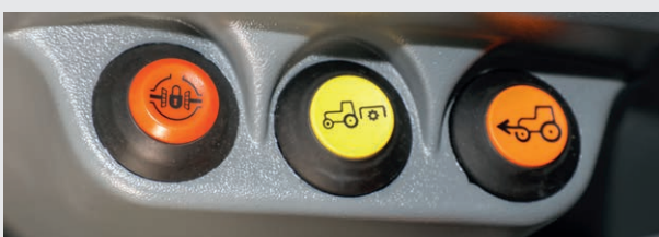
↑ De elektrohydraulische bediening van de aftakas garandeert een comfortabele inschakeling en een zachte aanloop van de aftakas.
