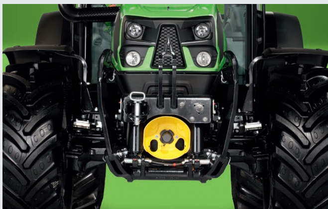
↑ De vooras is standaard uitgerust met twee geïntegreerde remschijven in een oliebad.
