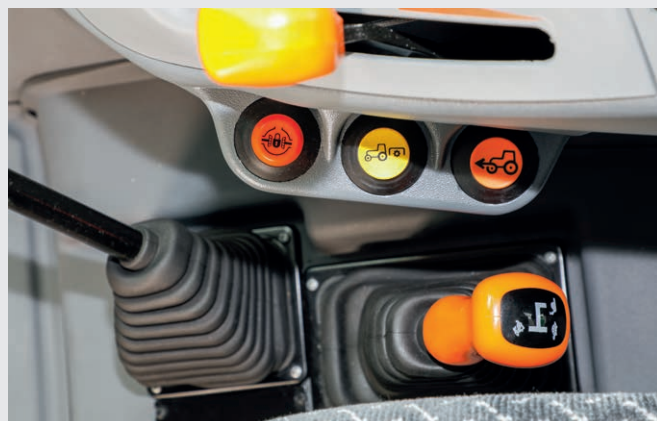
↑ Elektrohydraulische inschakeling van vierwielaandrijving en differentieelsper (LS en GS).
