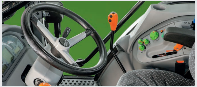
↑ Een telescopisch, kantelbaar stuurwiel kan zo worden gepositioneerd om het aan de bestuurder aan te passen.
