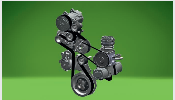
↑ De zelfstellende aandrijfriem is een onderhoudsvrije Multi V-riem met automatische spanner. Geen risico op slippen en dus oververhitting van de riem.
