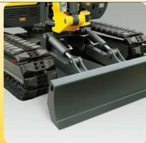
Orugas híbridas de vida útil prolongada, que se desplazan sin complicaciones sobre el asfalto y sobre superficies accidentadas cuyas almohadillas pueden reemplazarse de manera individual.
