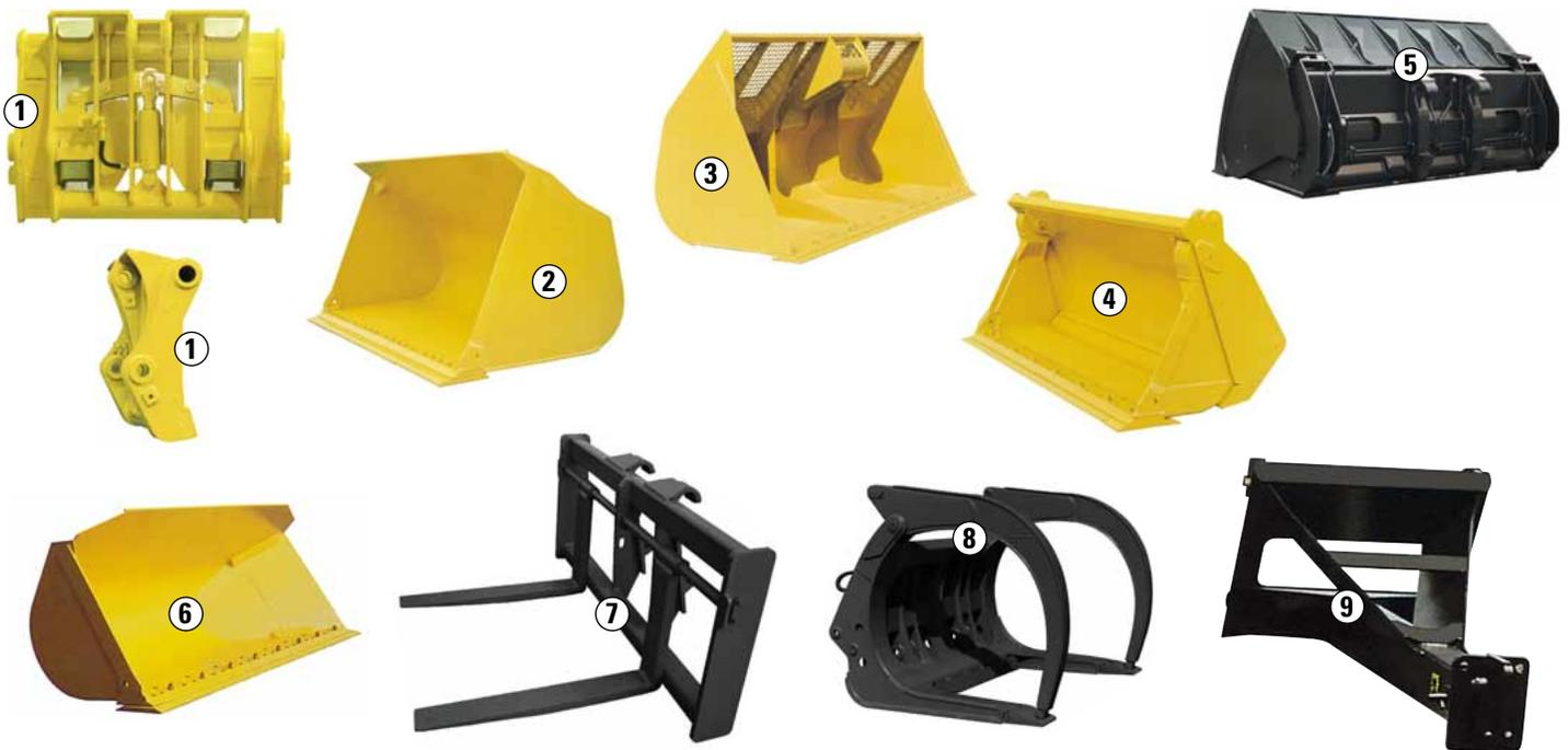
**1 Schnellwechseleinrichtung** – Mit dem Cat Schnellwechsler wird die Vielseitigkeit der Maschine deutlich vergrößert. Dank eines separaten Hydraulikkreises, der den sekundenschnellen Austausch der Arbeitsausrüstung von der Kabine aus ermöglicht, sind keine Umschalt-hähne erforderlich. Die durchdachte Konstruktion mit entgegengesetzt wirkenden Verriegelungskeilen bietet überzeugende Vorteile:
