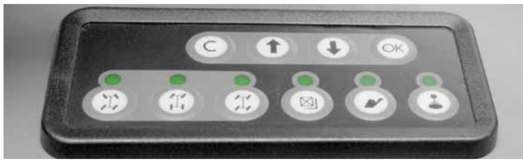
La modalità di sterzo desiderata è facilmente selezionabile mediante i tasti a membrana posti in cabina. Le ruote ritornano automaticamente in posizione rettilinea.
