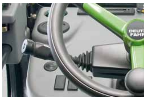
Il senso di marcia e le gamme di velocità sono facilmente selezionabili con il comando dell'inversore idraulico PowerShuttle posto sotto il volante di guida sul lato sinistro.
