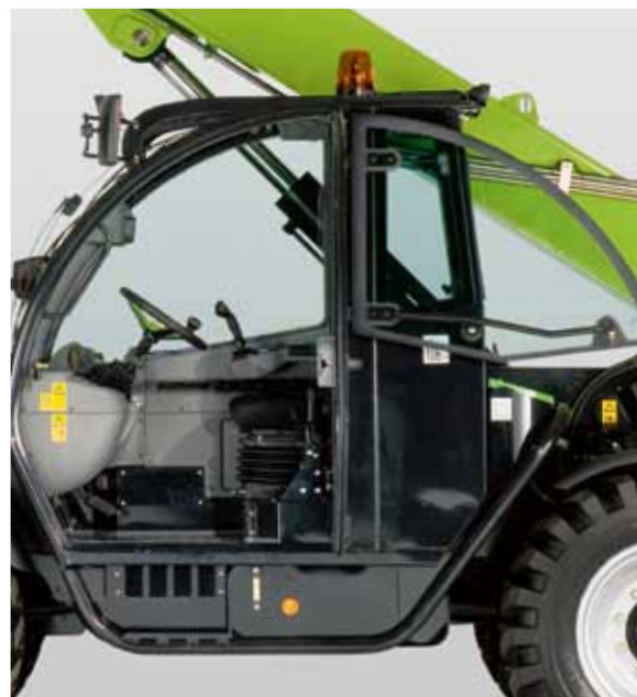
Il finestrino laterale può essere aperto di 180° all'indietro. Anche il finestrino posteriore è apribile.
