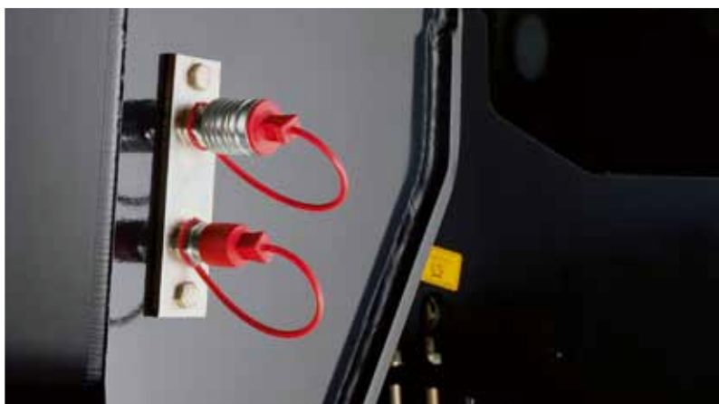
Di serie, è installato un distributore a doppio effetto con comando a distanza sul braccio telescopico.
