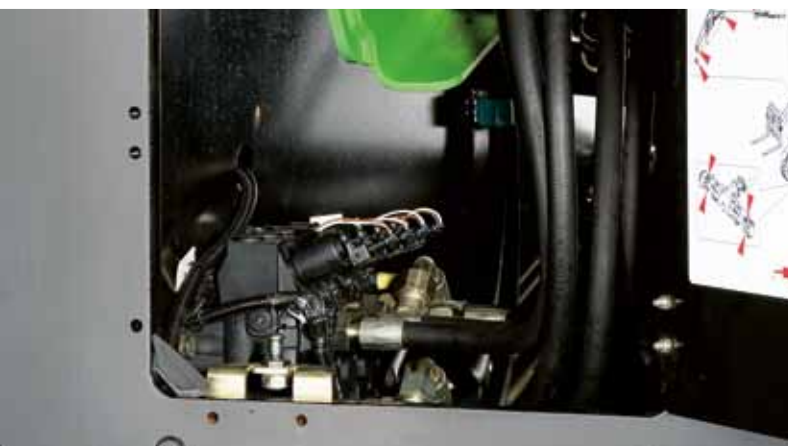
I distributori ausiliari dell'impianto idraulico sono compatibili con il cambio powershift e offrono il controllo proporzionale.
