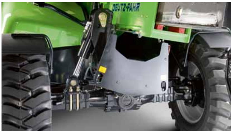
A richiesta i modelli 40.8 e 40.9 possono essere equipaggiati con unità di compensazione idraulica dell'inclinazione per \pm 9^\circ .
