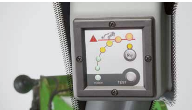
L'operatore può rapidamente valutare la stabilità del veicolo attraverso le lettere sul braccio interno e l'indicazione dei gradi sul quadro strumenti.
