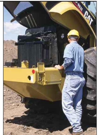
*Dank der einteiligen, nach vorn hochklippbaren Glasfaser-Motorhaube sind Dieselmotor und Kühlsystem bestens zugänglich. Die Wartungsstellen wurden vom Boden aus erreichbar auf einer Motorseite zusammengefasst.*
