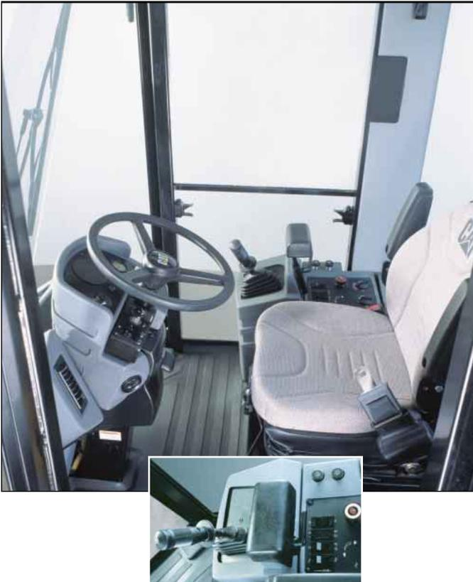
**Einhebelbedienung** zur mühelosen Steuerung von Fahrtrieb und Vibrationssystem. Die verstellbare, gepolsterte Handgelenkstütze ermöglicht ermüdungsarmes Arbeiten.
