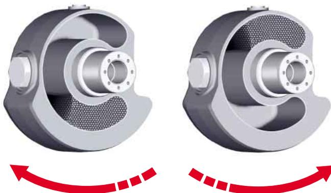
**Einfache Amplituden-Verstellung** vom Fahrstand aus, wobei die Drehrichtung der Vibratorwelle die Höhe der Amplitude bestimmt.
