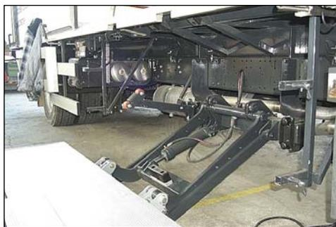
**DH-RC 750 kg** A montaggio laterale per carico / scarico dalle porte laterali del veicolo
