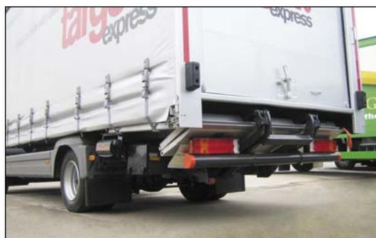
**DH-RC** 1000 kg - 1280 mm piattaforma totalmente in alluminio con barra paraincastro rotonda montata sui bracci di sollevamento
