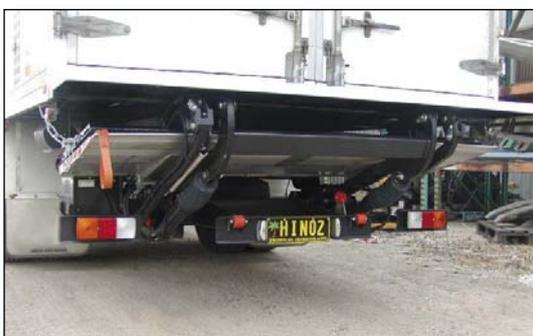
**DH-RM** 1500 kg - 1450 mm piattaforma in acciaio / alluminio con barra paraincastro in 3 pezzi
