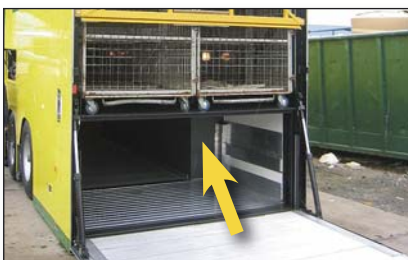
S728 Feste Plattform mit Hubzylindern (innere Hubladebühne)
