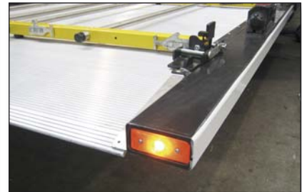
S708 Blinkleuchten montiert an Plattformspitze
