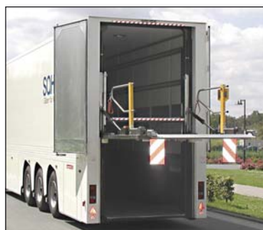
Kombinierte DH-VX Außen- und Innenhubladebühnen
