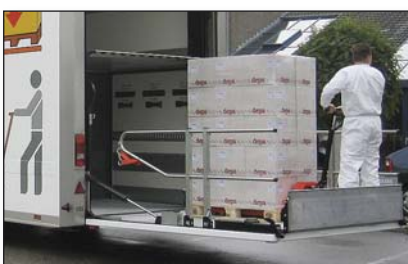
S764 / S765 Hydraulische Abrollsicherungen mit / ohne Auflagebalken
