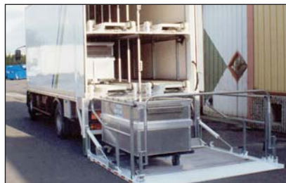
S732 Sicherheitsgeländer an drei Seiten für Rollcontainer
