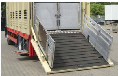
S709 Neigung der Plattform auf den Boden (max. 45° Rampenfunktion)
