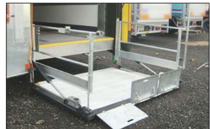
S751 Sicherheitsgeländer montiert an den Gleitschritten statt an der Plattform
