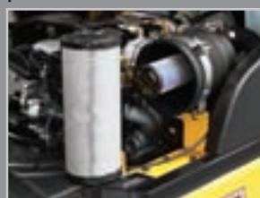
Cambio del filtro de aire (Tipo Cyclone de 6 pulgadas)
