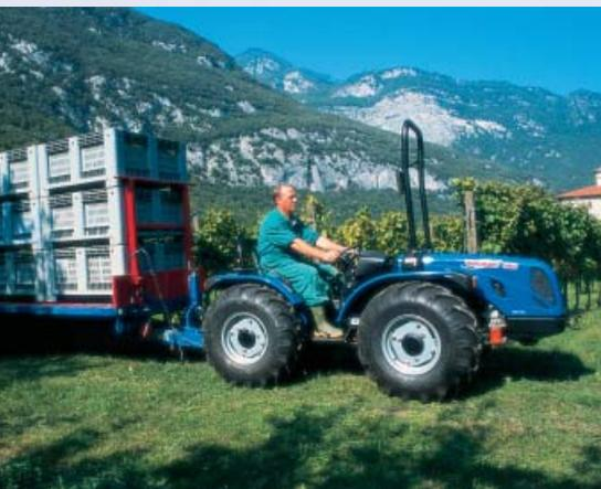
Les tracteurs VALIANT sont disponibles tant dans la version Monodirectionnelle de type traditionnel, que dans la version Réversible avec la possibilité de tourner le poste de conduite (siège-volant-tableau de bord) en 5 secondes seulement, sans débrancher aucune connexion.
