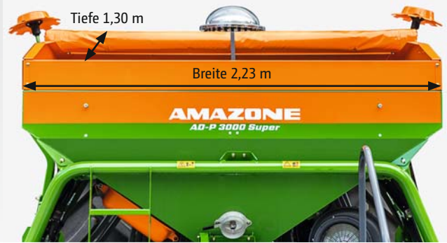
Großer Saatgutbehälter mit 1500 l + 500-l-Aufsatz
