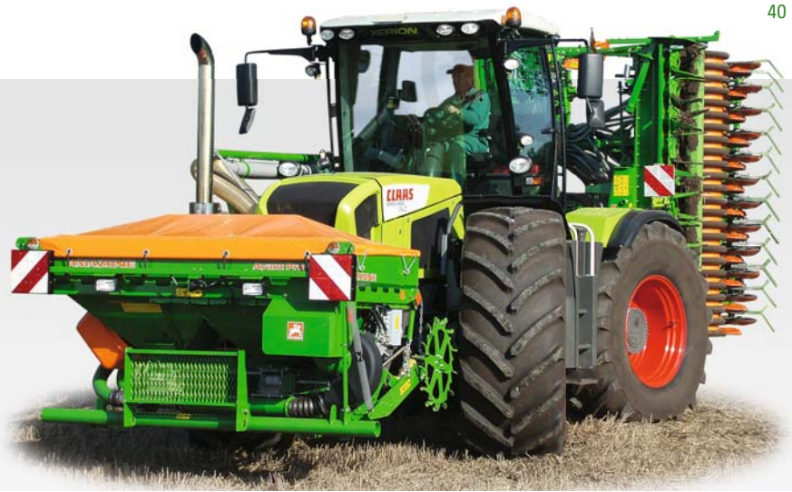
Avant 6001-2 mit Frontsaatgutbehälter FRS mit Frontanbauahmen und Spornradantrieb
