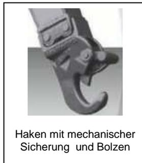
Haken mit mechanischer Sicherung und Bolzen
