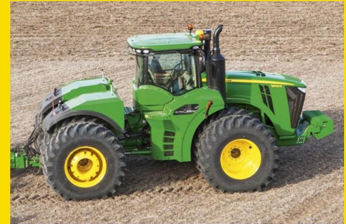
Трансмиссия e18 с системой Efficiency Manager обеспечивает максимальную эффективность при любых рабочих условиях. Система автоматического вождения, работающая на базе системы глобального позиционирования GPS, позволяет уменьшить нагрузку на оператора и создать комфортные условия для его работы.
