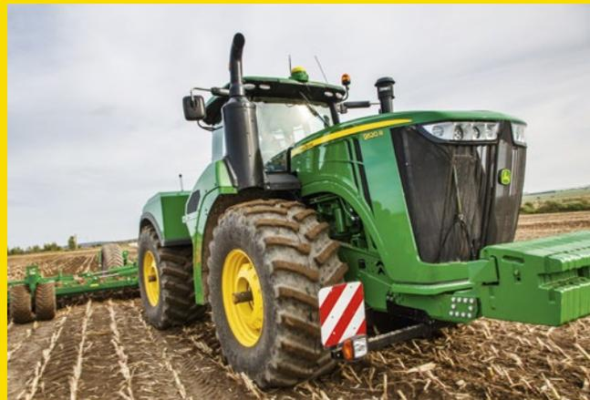
Тракторы серии 9R обеспечивают оптимальное соответствие рабочей передачи оборотам двигателя за счет трансмиссии e18 с системой управления эффективностью Efficiency Manager, что позволяет снизить общий расход топлива.
