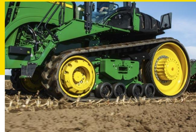
Большие ведущие колеса и опорные катки обеспечивают высокую надежность и отличное сцепление.
