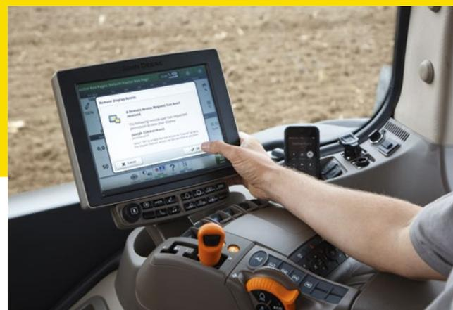
RDA является мощным инструментом обучения операторов и позволяет получать данные с монитора GreenStar в режиме реального времени.
