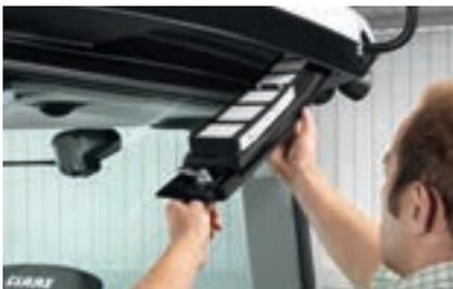
Der Kabinenluftfilter ist außen an der Kabine angebracht und lässt sich zur Wartung einfach entnehmen.
