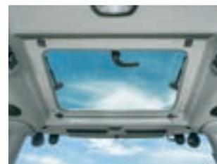
Dank der Glasdachluke hat der Fahrer immer gute Sicht auf den Frontlader und kann so jederzeit sicher und präzise arbeiten.
