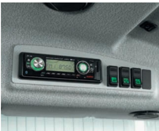
Oben links im Kabinendach sind die Konsole für ein Radiosystem, der Rundumlichtschalter und zwei Schalter für Arbeitsscheinwerfer untergebracht.
