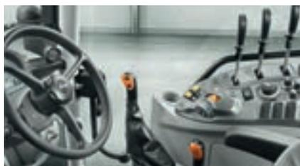
Alle Gruppen und Gänge werden über zwei Schalthebel betätigt. Ein Kupplungsknopf am Gangschalthebel ist alternativ zur Fußkupplung nutzbar.
