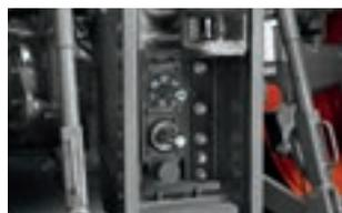
Für gezogene Geräte mit Triebachse ist eine Wegzapfwelle verfügbar. Diese ist unterhalb der Heckzapfwelle separat angebracht.
