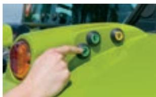
An beiden Kotflügeln hinten ist das Anheben und Absenken des Heckkrafthebers über dieses Tastenfeld möglich.
