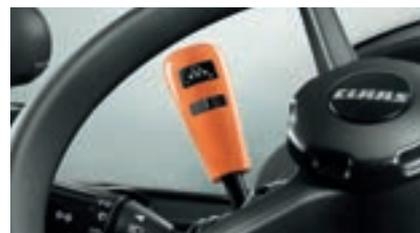
Mit der REVERSHIFT Wendeschaltung erfolgt die Einstellung der Reversierprogressivität am REVERSHIFT Hebel.
