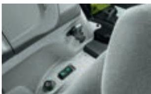
Rechts neben dem Fahrersitz ist ein weiterer Taster angebracht, mit dem sich der Heckkraftheber beim Geräteanbau steuern lässt.
