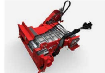
Les barres de coupe sont disponibles jusqu'à 9,20 m (30 ft), le convoyeur est équipé par le nouveau rouleau à spirale et le bac à pierres.
