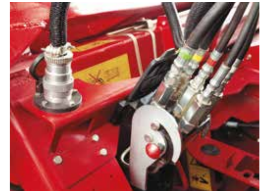
Dank Multikuppler für die Hydraulik ist das Ankoppeln des Vorsatzes in wenigen Minuten erledigt
