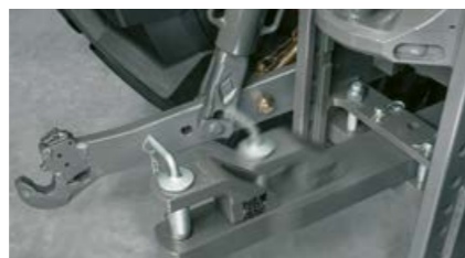
Bei den Zugpendelvarianten sind mehrere Positionen möglich. Die ausgezogene Position verbessert die Wendigkeit.
