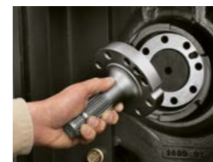
Einfacher Wechsel der Zapfwellenstummel
