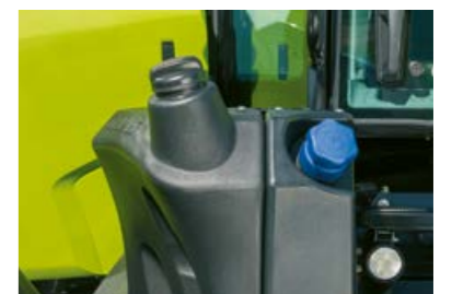
455-l-Kraftstofftank mit eingelassenem 42-l-Harnstoffvorrat
