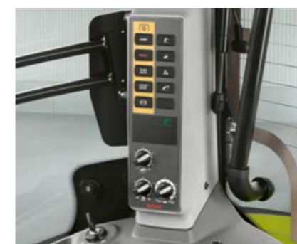
Zapfwellengeschwindigkeiten und elektronische Heckkraftheberregelung am B-Holm einstellbar
