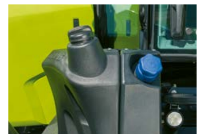
455 liter brandstoftank met geïntegreerd 42 liter ureumtank
