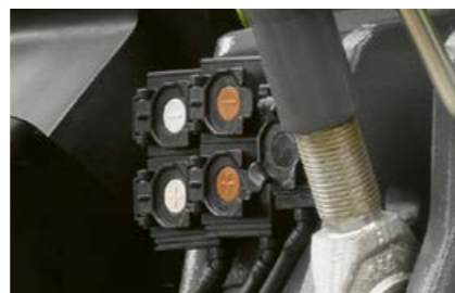
In combinatie met de frontheffinrichting zijn max. vier hydr. aansluitingen en een vrije retour aan de voorzijde leverbaar. Ideaal voor een zaadtank of een schuifblad in de frontheff.
