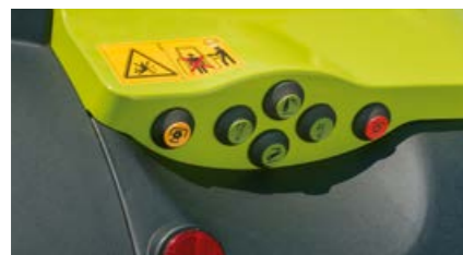
Externe bedieningselementen voor de achterhefinrichting, aftakas en een te kiezen regelventiel (alleen met CEBIS).
