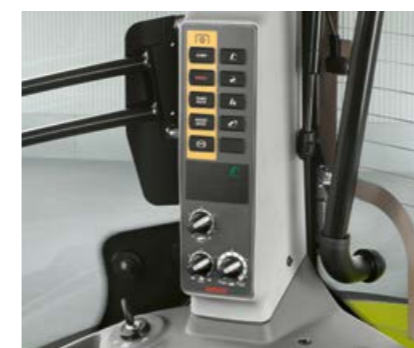
Aftakassnelheden en elektronisch geregelde hefinrichting op de B-stijl in te stellen.
