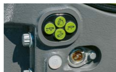
Externe bediening voor de fronthef en een regelventiel in de CEBIS-uitvoering
