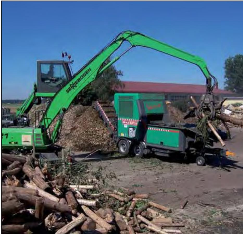
■ JES wird durch die serienmäßige VARIO-Flex-Steuerung ergänzt. Das Motormanagement wird durch den Betreiber optimiert, indem eine dem Material angepasste optimale Drehzahl im grünen Lastbereich des Motors ausgewählt wird. Das Resultat: der Kraftstoffverbrauch kann so auf 0,3 l / m<sup>3</sup> produzierte Biomasse reduziert werden.
