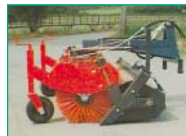
Bac de ramassage monté sur une lame de frottement avec réglage en hauteur
