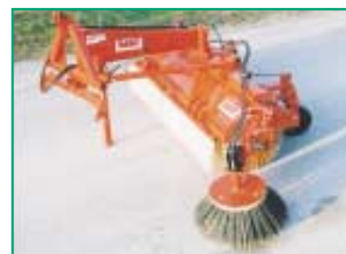
Balai latéral ø 700 avec réglage en hauteur et réglage du déport
