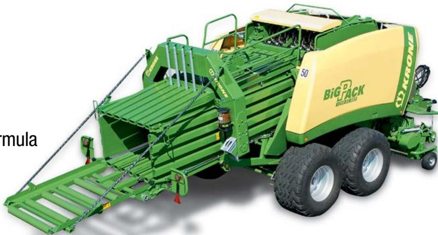
HDP (High-Density-Press) è la nuova formula magica di KRONE per balle quadre con la massima densità. Il modello KRONE BiG Pack 1290 HDP, con misure canale di 120 x 90 cm e canale di pressatura allungato raggiunge livelli di densità prima sconosciuti. In rapporto a sistemi tradizionali le presse quadre HDP raggiungono un peso balla superiore fino al 25%.
