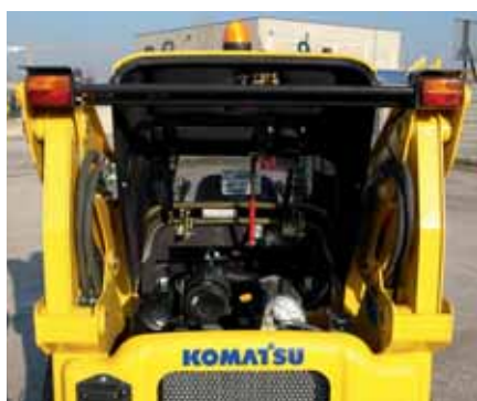
Kryt motoru: rychlá kontrola motoru
