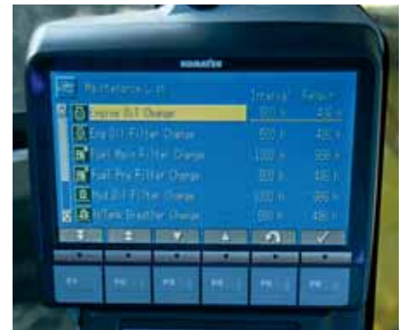
Der LCD-Monitor zeigt Unregelmäßigkeiten und Wartungsintervalle an
