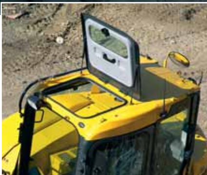
Aufklappbare Dachluke für optimale Sicht nach oben
