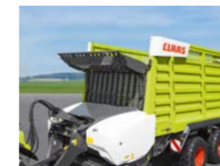
Hydraulisch nach vorne schwenkbare Befüllklappe
