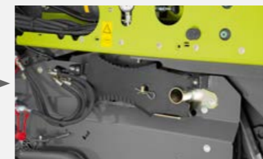
Zweiten Messersatz aus der Parkhalterung einbauen
