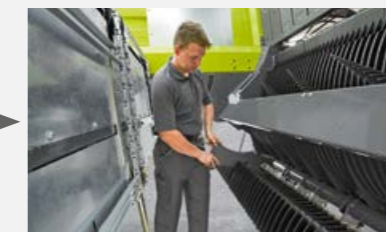
Messer drehen, weiterfahren mit geschliffenen Messern
