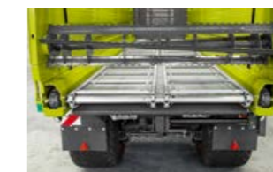
Zwei leistungsfähige Hydromotoren in Kombination mit dem Zweistufenantrieb garantieren ein schnelles Entladen.
