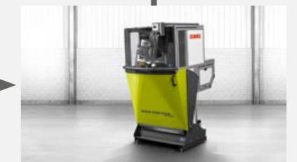
Anschließend beide Messersatz mit AQUA NON STOP COMFORT im einzigartigen Nassschleifverfahren schleifen
