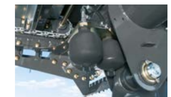
Druckspeicher für die optional erhältliche Deichselfederung
