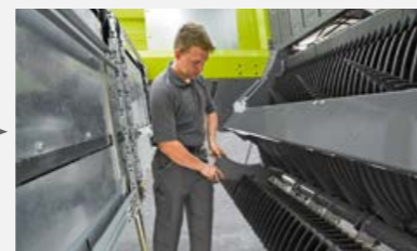
Messer drehen, weiterfahren mit geschliffenen Messern
