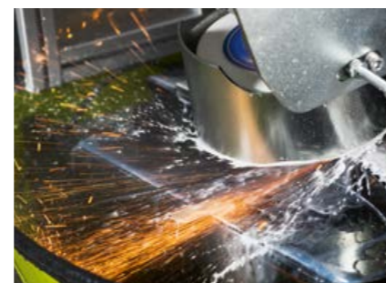
Durch einen immer korrekten Schleifwinkel bleiben Originalradius und -kontur des Messers erhalten.
