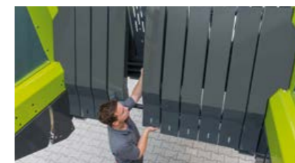
Einlegen der Kanalabdeckung
