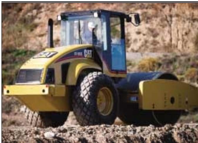
**Капот выполнен наклонным**, благодаря чему оператор в состоянии увидеть препятствие высотой 1 метр, находящееся всего в 1 метре позади машины, то есть обзор назад не хуже, чем обзор вперед. Это очень ценное качество, в особенности при работе рядом с препятствием и в ограниченных пространствах, а также при маневрировании по рабочей площадке.
