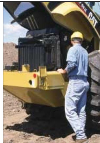
**Цельный стеклопластиковый капот** откидывается, обеспечивая исключительно удобный доступ к двигателю и системе охлаждения. Точки технического обслуживания доступны с уровня грунта и сгруппированы на одной стороне двигателя.
