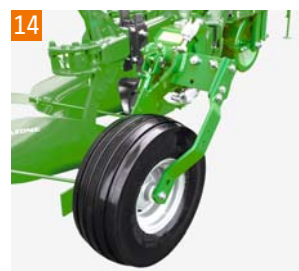
14 Rad-Ø 680 mm luftbereift x 250 mm Breite – schwere Ausführung (doppelstielig) Verfügbar für: Alle 6-scharigen sowie 5-scharigen S- und/oder V-Pflüge
