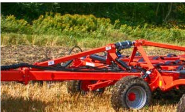
La transferencia automática de peso estándar aumenta la tracción del tractor y reduce la fuerza de tracción requerida, el consumo de combustible y el desgaste de los neumáticos.
