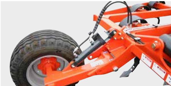
CU1000T: Ajuste delantero mediante ruedas de control..
