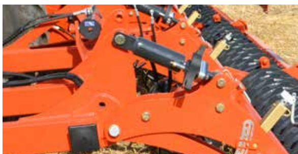
Le réglage de la profondeur à l'arrière s'effectue à l'aide du rouleau.
