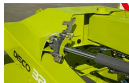
Flexibel: werkzeuglose Deichselverstellung für die schnelle Anpassung an verschiedene Traktoren (Option)
