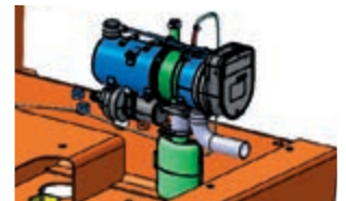
Calentador del refrigerante del motor Mejora la capacidad de arranque en condiciones de frío extremo calentando el refrigerante y el combustible.
