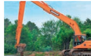
Super Long Reach – SLR ja Semi SLR Pitkän ulottuvuuden koneemme sopivat ihanteellisesti maalta ja vedestä tehtävään toimintaan, koska niiden enimmäisulottuvuus on lähes 20 metriä.
