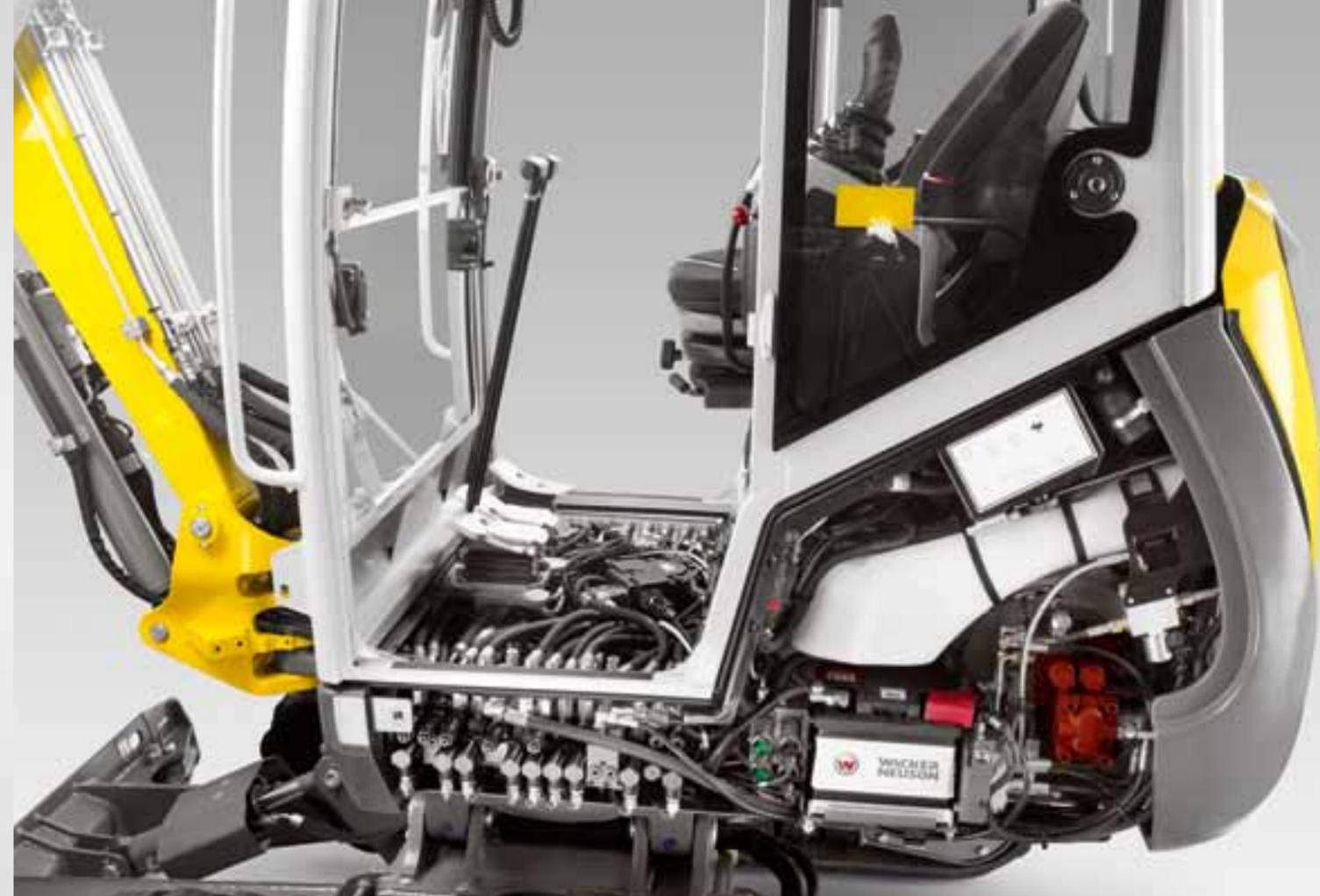
**1 Plus cool, plus durable et plus robuste.** La série ET offre un concept de refroidissement inédit qui assure une résistance thermique extrêmement élevée grâce à une conduite d'air froid d'un nouveau type. Il permet de travailler à pleine charge avec une température ambiante pouvant atteindre 45 °C. Le niveau de température en général plus bas dans l'ensemble du système hydraulique augmente la durée de vie des composants.
