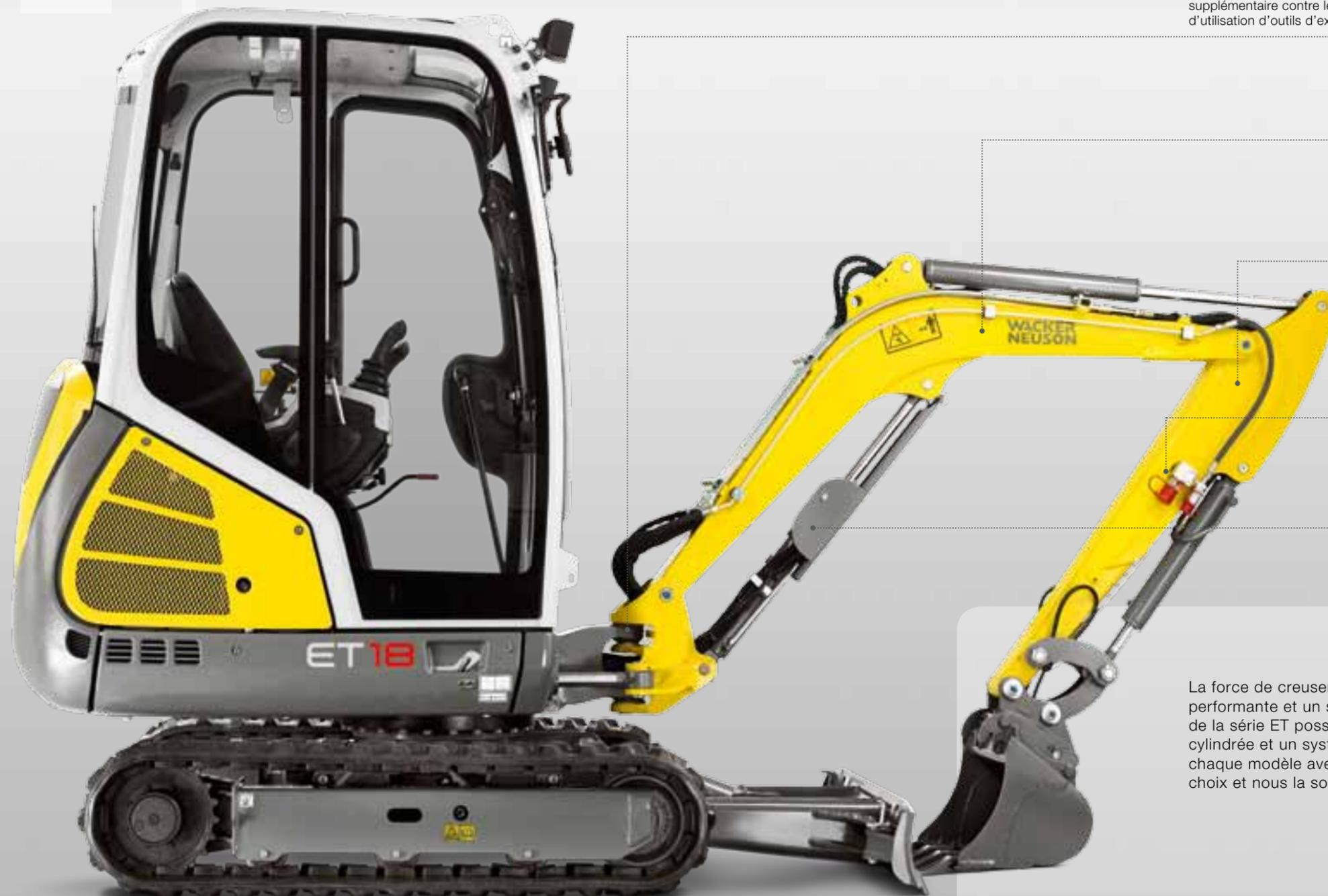
**Une vue dégagée et une protection parfaite.** La conduite reliant la flèche au châssis passe par une console orientable en deux parties. D'où une protection intégrale et une vision optimale.
