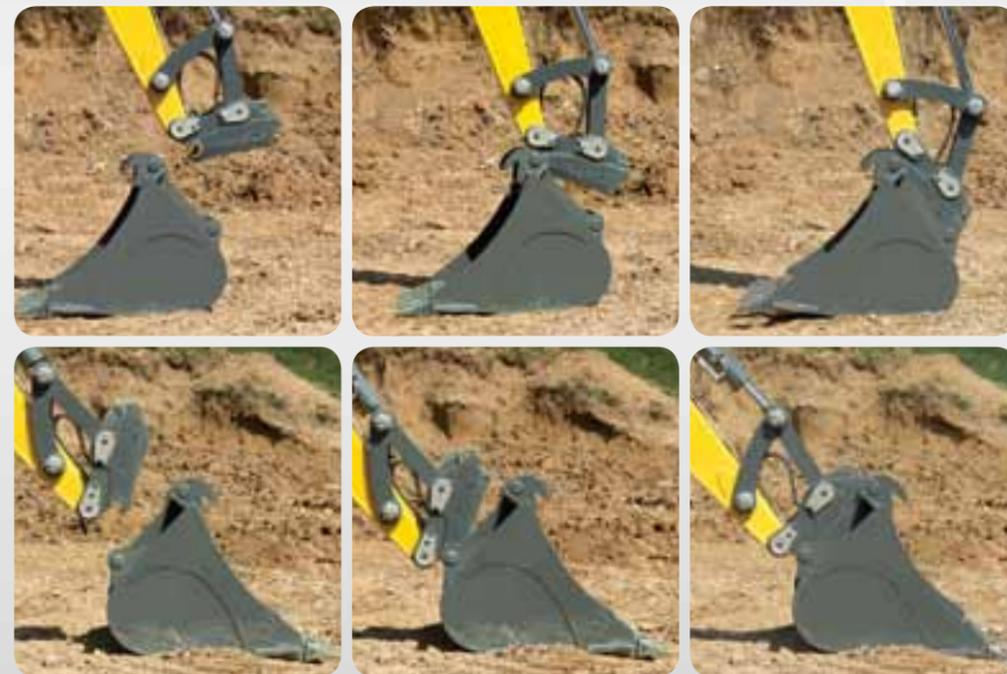
**Habile en mode rétro et chargeur.** Un simple pivotement suffit pour utiliser le godet comme un godet chargeur. D'où un gain de temps, mais aussi une augmentation intelligente de la flexibilité de la pelle.
