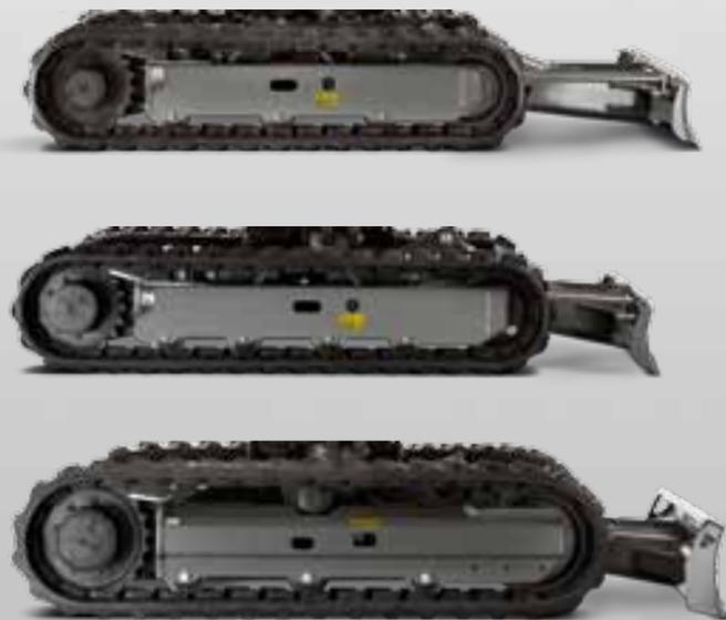
**Les châssis (ET18, ET20) avec 2 variantes de lames niveleuses.** Ça aussi c'est convaincant. Vous pouvez choisir entre deux longueurs de lames niveleuses pour les châssis de la série ET (ET18, ET20) optimisés en fonction de chaque modèle. Cela permet de s'adapter de façon optimale aux outils d'extension. De même, le système de correcteur de dévers VDS – le nec plus ultra – est également disponible en option pour tous les modèles de cette classe.
