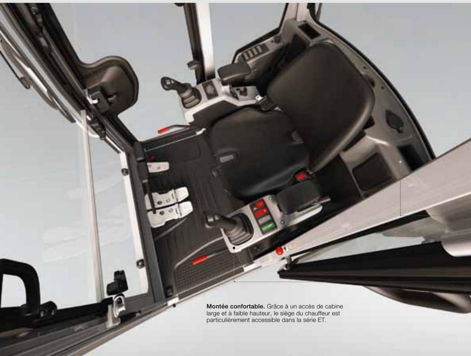
**Montée confortable.** Grâce à un accès de cabine large et à faible hauteur, le siège du chauffeur est particulièrement accessible dans la série ET.
