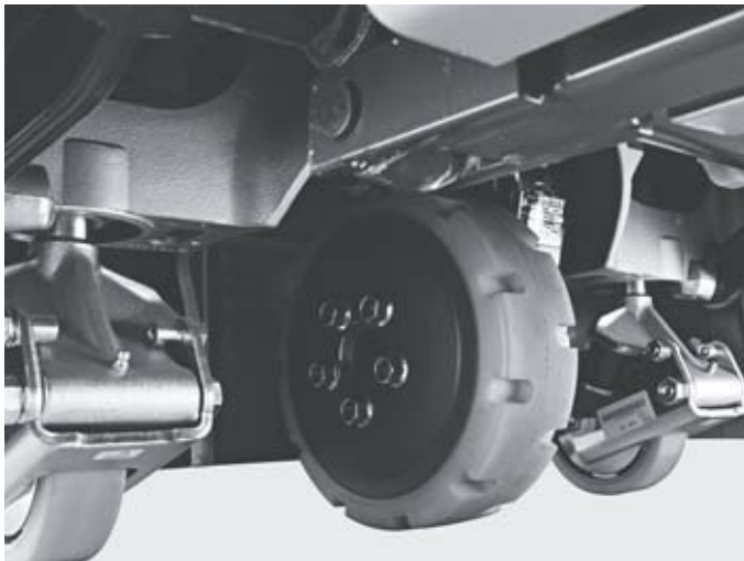
Chasis robusto y ruedas de apoyo hidráulicas para un movimiento potente en rampas
