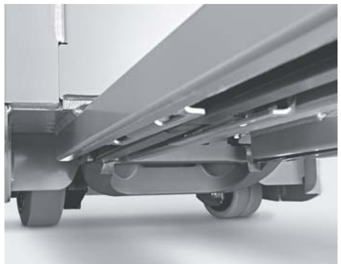
Nivelación automática opcional para suelos irregulares y para optimizar el comportamiento de marcha
