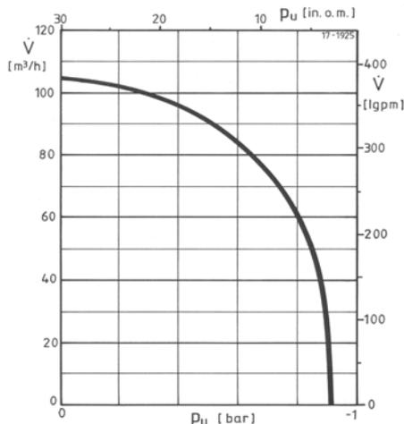
Vakuumpumpe Bezug: Ansaugdruck
