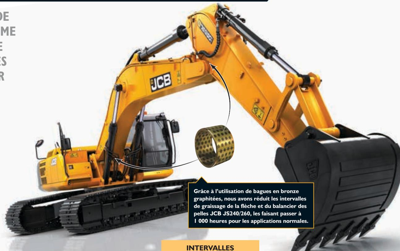
Grâce à l'utilisation de bagues en bronze graphitées, nous avons réduit les intervalles de graissage de la flèche et du balancier des pelles JCB JS240/260, les faisant passer à 1 000 heures pour les applications normales.
