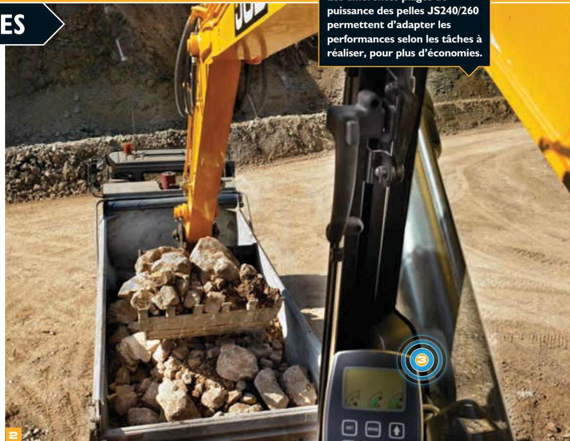
Les différentes plages de puissance des pelles JS240/260 permettent d'adapter les performances selon les tâches à réaliser, pour plus d'économies.
