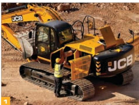
**1** Le capot des pelles JCB JS240/260 s'ouvre d'avant en arrière pour offrir un accès facile et sûr au moteur.
