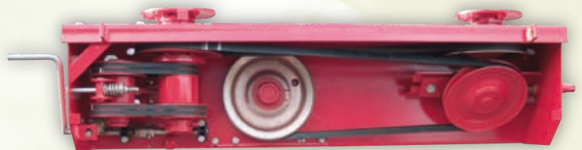
Streuwerk SPC4500-1 mit Randstreugetriebe.
