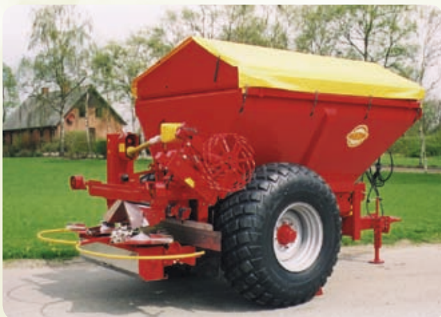
Modell K45 mit Bereifung der Größe 16,9 x 30, Streuvorrichtung mit Streubreiten 12-36 m, Behälteraufsatz, Plane, Plane über dem Streuwerk und hydraulischer Dosierregelung.
