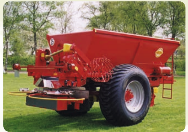
Modell K85 mit Bereifung der Größe 650/65 x 30,5 mit Streuvorrichtung – Streubreiten: 12-16 m Kalk bzw. 12-24 m Mineraldünger.
