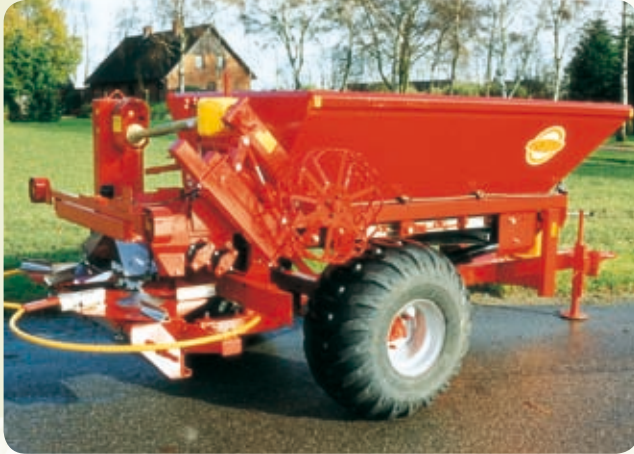
Modell K40 mit Bereifung der Größe 425/65 x 22,5 mit Streuvorrichtung – Streubreiten: 12-16 m Kalk bzw. 12-24 m Mineraldünger.
