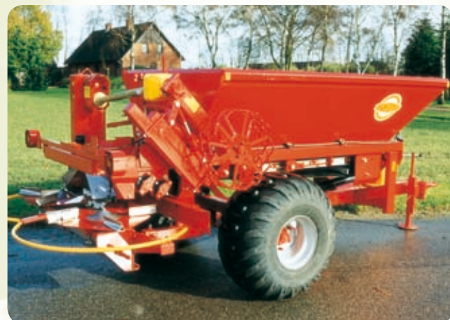
K40 z oponami 425/65 x 22,5, wyposażeniem do rozkładania wapna 12-16 m/nawozów 12-24 m.
