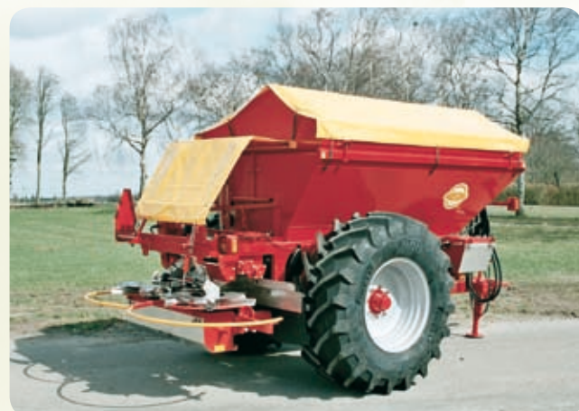
K45 z oponami 16,9 x 30, wyposażeniem do rozkładania nawozów 12-36 m, przedłużką kosza, osłoną systemu wysiewającego i dozowaniem sterowanym hydraulicznie.
