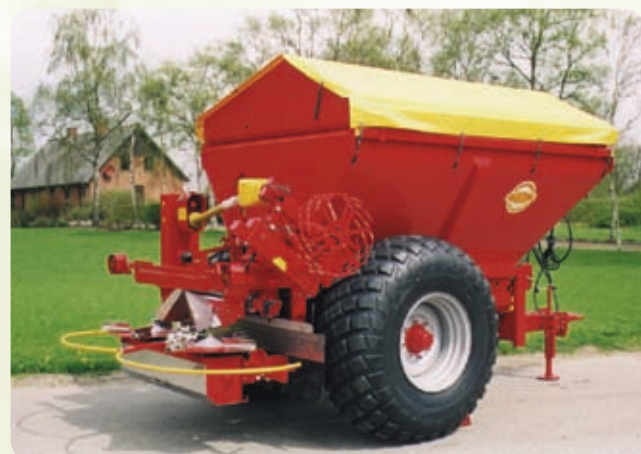
K45 z oponami 16,9 x 30, wyposażeniem do rozkładania nawozów 12-36 m, przedłużką kosza, osłoną systemu wysiewającego i dozowaniem sterowanym hydraulicznie.
