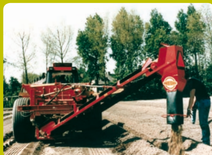
Rozkładarka piasku Bredal. Do instalacji w modelach K45-K105.
