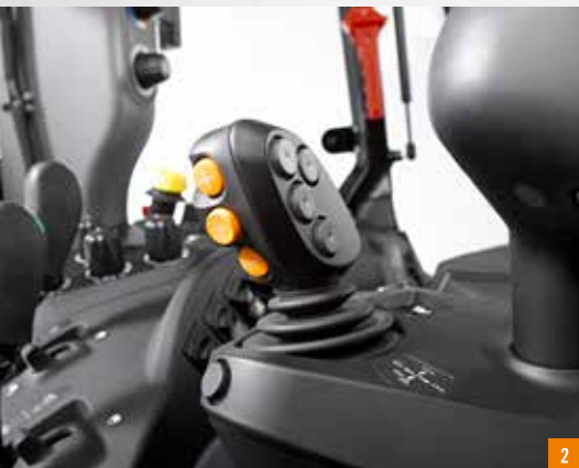
1 Joystick para tareas con pala frontal en los modelos PROFI, PROFI CVT y CVT
