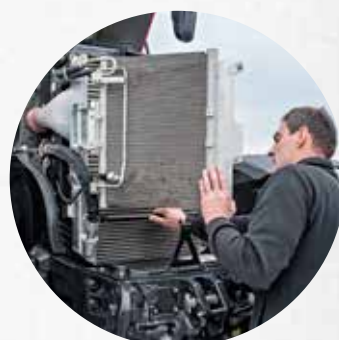
Snelle en eenvoudige reiniging van de koeler en de airconditioning.
