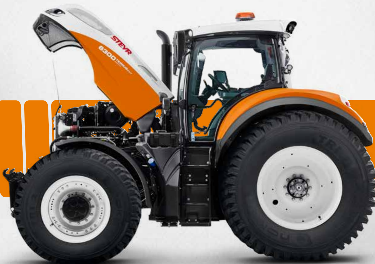
Continue reiniging via een piclon-filter zorgt ervoor dat het filter alleen hoeft te worden onderhouden wanneer het betreffende waarschuwingslampje aan gaat.
