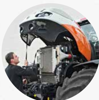
De eendelige motorkap met gasveer kan in twee standen (45°/90°) omhoog worden gezet, ook met aan de voorzijde aangebouwd werktuig.
