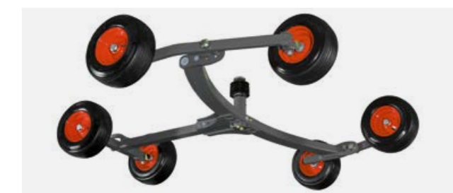
Die Tandemachse: Damit kann der Landwirt mit idealer Zinkenführung noch schneller fahren.
