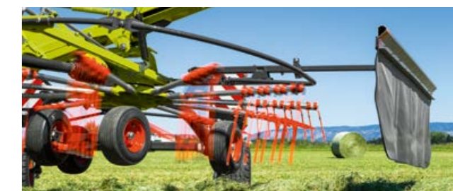
Das einzigartige Rahmenkonzept der CLAAS Seitenschwader ermöglicht Aushubhöhen bis 70 cm.
