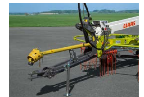
Parallelogramm-Deichsel optional beim LINER 700 TWIN, serienmäßig beim LINER 800 TWIN.
