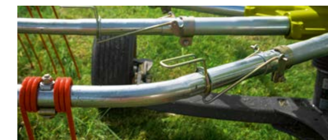
Geschützt im Kollisionsfall: Die Arme knicken kontrolliert an definierten Stelle ein.
