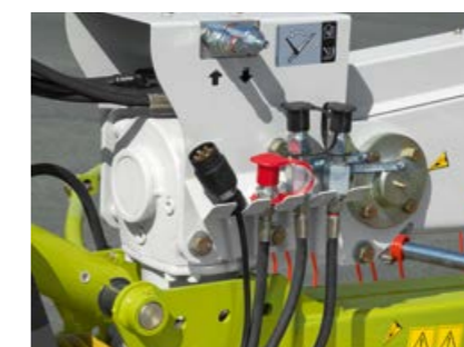
Comando sequenziale idraulico di serie per sollevamento e abbassamento differenziato della girante anteriore e posteriore.
