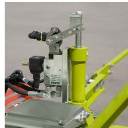
Nella versione comfort i due andanatori a quattro giranti sono disponibili con regolazione elettro-idraulica dell'altezza di lavoro.
