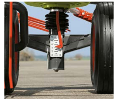
Regolazione facile dell'altezza di lavoro grazie alla scala graduata
