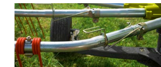
Protetti in caso d'urto: i bracci si piegano in modo controllato in un punto predefinito.
