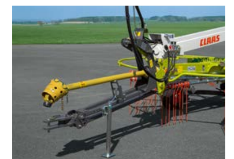
Timone a parallelogramma a richiesta per i LINER 700 TWIN, di serie per i LINER 800 TWIN.
